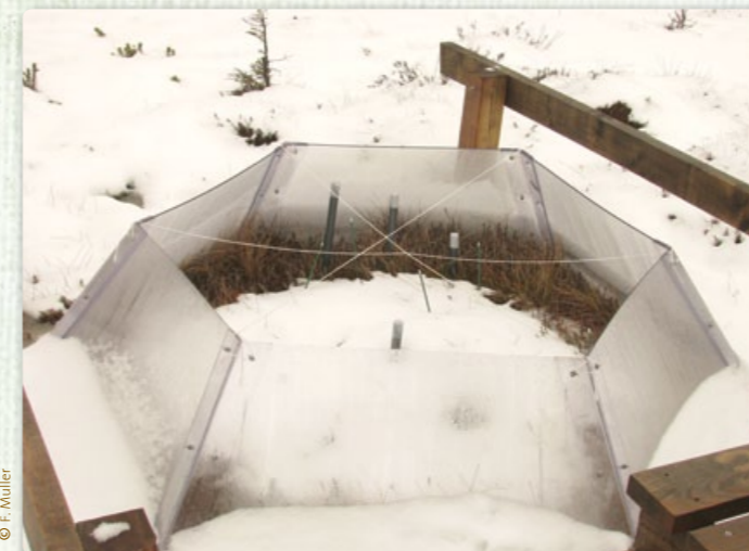
Des chambres à ciel ouvert en plexiglas peuvent simuler une augmentation de l'effet de serre. Programme Peatwarm, tourbière de Frasne (25).
